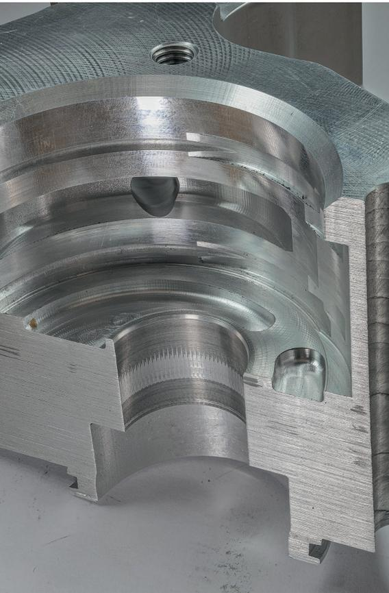
1 Innenseite des zu entgratenden Hydraulikbauteils beim Anwender Stemplinger. Ein und dieselbe Ibex-Bürste von Kempf macht die Wandungen und die Bohrungsausritze sekundärgratfrei und bearbeitet auch die äußeren Planflächen © Kempf
