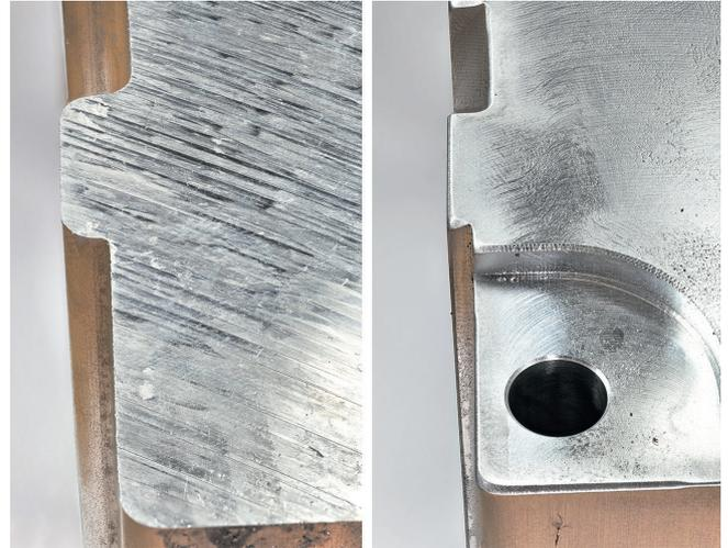
**6** Ein weiteres Segment des betreffenden Teils. Aufgrund der zusätzlichen Anwendung der Keramikfaser-Oberflächenbürste wird auch der Sägeschnitt an der Werkstückoberfläche egalisiert, und die Kanten/die Konturen werden zusätzlich abgerundet. Damit entsteht ein sauberes Entgratbild an der Kontur © Kempf
