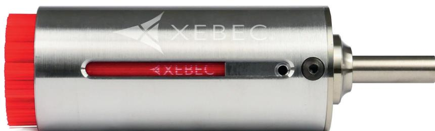
3 Die hier verwendete 40-mm-Keramikfaser-Oberflächenbürste 'BÜA11-CB40M'. Ihre roten Keramikfasern sind hoch flexibel und eignen sich deshalb für das Feinentgraten von Aluminium, Kupfer oder Messing. Ist die Bürste verschlissen, wird sie aus der Aluhülse entnommen und ausgetauscht © Kempf
