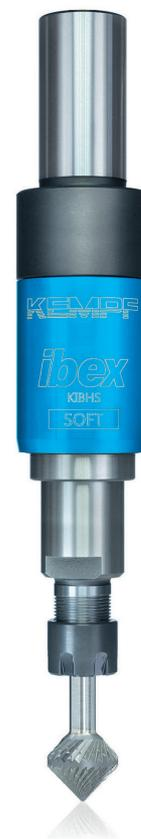
2 Ein Ibex-Entgratsystem besteht aus einem Ausgleichshalter und hier einem Vor- und Rückwärtsfräser mit spezieller CrossCut-Verzahnung. Eine hochfeste, speziell abgedichtete Aluminiumhülse verhindert das Eindringen von Staub und Spänen © Kempf
